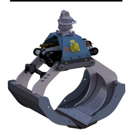
Cette benne preneuse est développée pour utilisation dans des grue-Z de HIAB et est livré avec le disque pour bloquer la benne sur la grue quand il est plié. Utilisée pour manutention, terrassement, reprise de matériaux etc. Puisque la benne est équipée de crochets de manutention, il est aussi possible de l'utiliser en levage de charges. L'utilisateur est tenu d'utiliser des équipements de levage approuvés (chaînes, élingues, crochets etc.).
