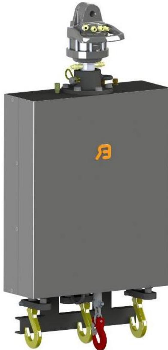
Der GEJO 10 Hakengreifer ist besonders geeignet für die Entleerung von über- und unterirdischen Abfallcontainern. Dieser hydraulische Hakengreifer wird elektrisch bedient. Auf diese Weise können Sie die Funktionalität des Hakengreifers optimal nutzen. Der GEJO 10 Hakengreifer hat zwischen den Haken eine feste Breite von 250mm. Dieser Hakengreifer wird mit einer elektrischen 24 V-Bedienung (excl. Montage an den Autoladekran) geliefert.
