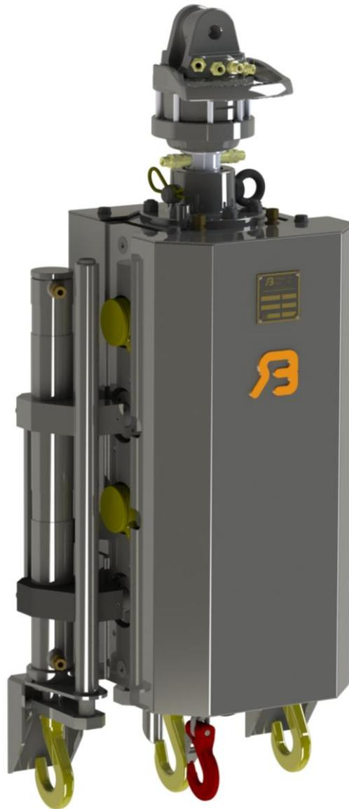
Der GEJO 20 Hakengreifer hat sich bezüglich der Entleerung von über- und unterirdischen Abfallcontainern eine Topposition im Markt erobert. Der hydraulische Hakengreifer GEJO 20 wird elektrisch bedient. Auf diese Weise können Sie die Funktionalität des Hakengreifers optimal nutzen. Die Breite des Hakengreifers ist mittels 4 hydraulischen Zylindern stufenlos einzustellen, wodurch der Container immer in Waage unter dem Hebepunkt des Autokrans hängt.
